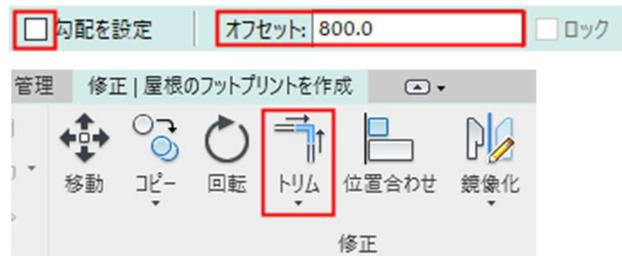
2.3.8. [修正]タブ-[修正]パネル-[トリム]を選択し、適宜トリムして屋根のライン全体を整える
