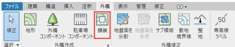
1.5.3. プロパティパレットから「舗装 1」を選択し、「基準レベルオフセット」を「-100」に設定
