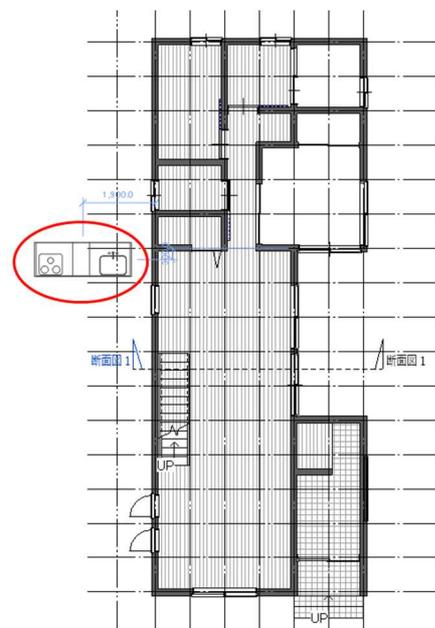
配置する際、キーボードの「スペースキー」を押すとコンポーネントが反時計回りに回転するので、3回押して270度回転させ（半角英数入力となっていることを確認）、右図の位置に配置
