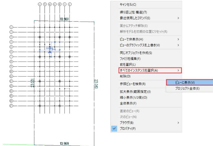
「プロパティパレット」の「基準レベル」を「土台天端」、「上部レベル」は「2F 梁天」のまま「上部からのオフセット」を「-240」(梁高さ)に設定
