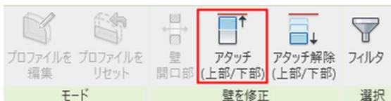
[修正]タブ-[壁を修正]パネル-[アタッチ]を選択し、「3Dビュー」で上下屋屋根をクリック
