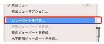
**作成するレイヤ**を「Sht-2 [シートレイヤ]」、**縮尺**を「1:100」と設定し、**OK** をクリックします。
