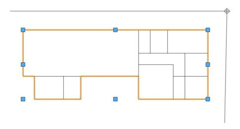
入力した多角形を選択した状態で、属性パレットの面属性をクリックしハッチングをかけます。必ずしもハッチングでなくてもカラー表示でもいいです。好みで選択してください。
