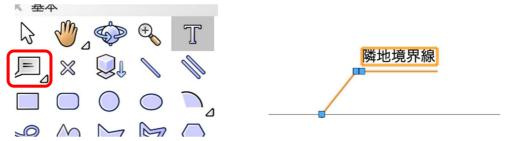
このツールの特徴はその名の通り、引出線が付いた注釈文字を図面に簡単に置けることです。その操作は、 注釈文字を配置しその都度内容に応じて書き込みすることもできますが、更には図面種類に応じてデータベ ースが利用できるのが大きな特徴です。
