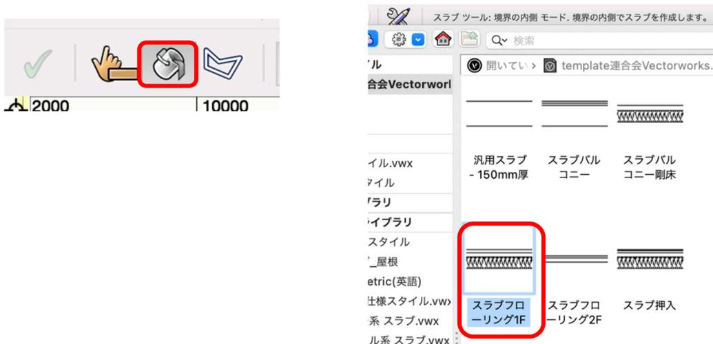
LDKの床を入力します。バケツになっているカーソルをLDK内のどこでもいいのでクリックします。
