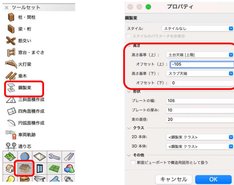
鋼製束を設置する箇所をクリックするか、**配列複製**を使うなどしてモデリングします。
