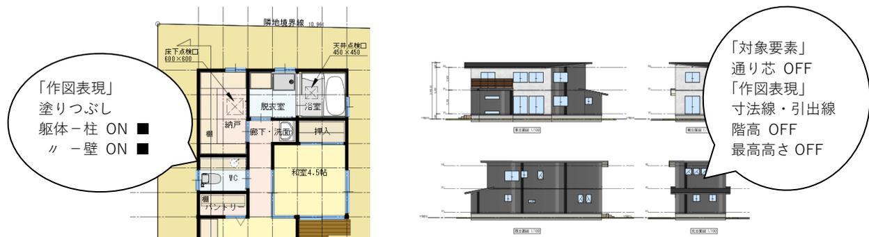
「図面」タブの「図面再作成」を利用することで、作図条件の変更結果を確認できます。「図面再作成」は作図条件の変更のほか、縮尺の変更や生成範囲の変更、モデルに変更があった場合の図面更新などに利用します。
