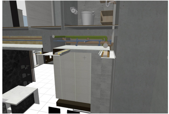
■ 図表 8-4-4 施工技術コンサルティングへの BIM 活用例 (左：仮設計画を 3D 上で確認、右：配管との取り合いを 3D 上で確認)
