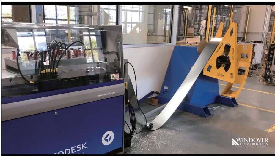
■ 図表 4-4-3 加工機が間仕切を作成している様子
