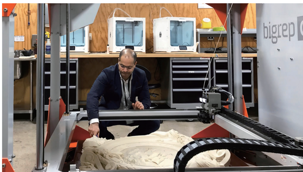
■ 図表 4-4-5 ProHT で外壁装飾を 3D プリントしている様子
